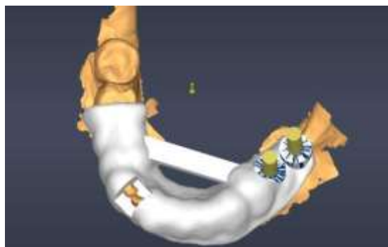
[Szablon po dodaniu poprzeczek i okien]
